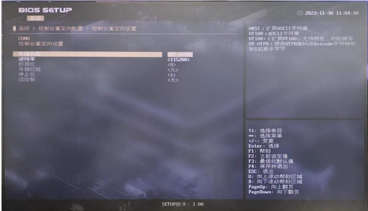
图 3-13 控制台重定向设置界面
