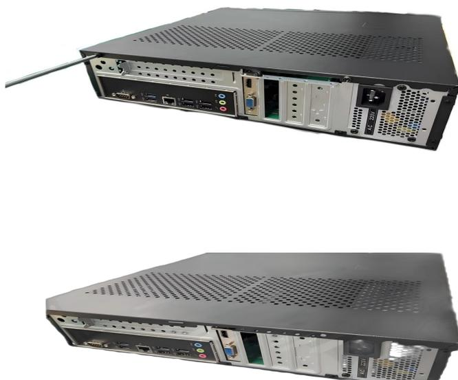
图 2-3 开启机箱盖示意图
