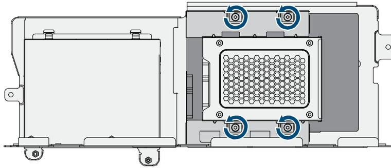
图 2-10 3.5 寸硬盘螺丝位置示意图
