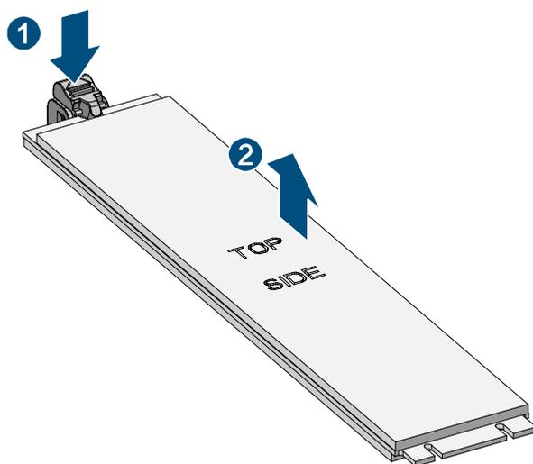
图 2-12 M.2 SSD 拆装示意图
