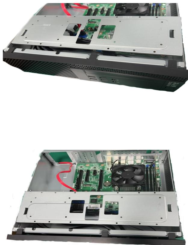
图 2-4 前面板拆装示意图
