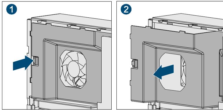
图 2-5 导风罩拆装示意图
