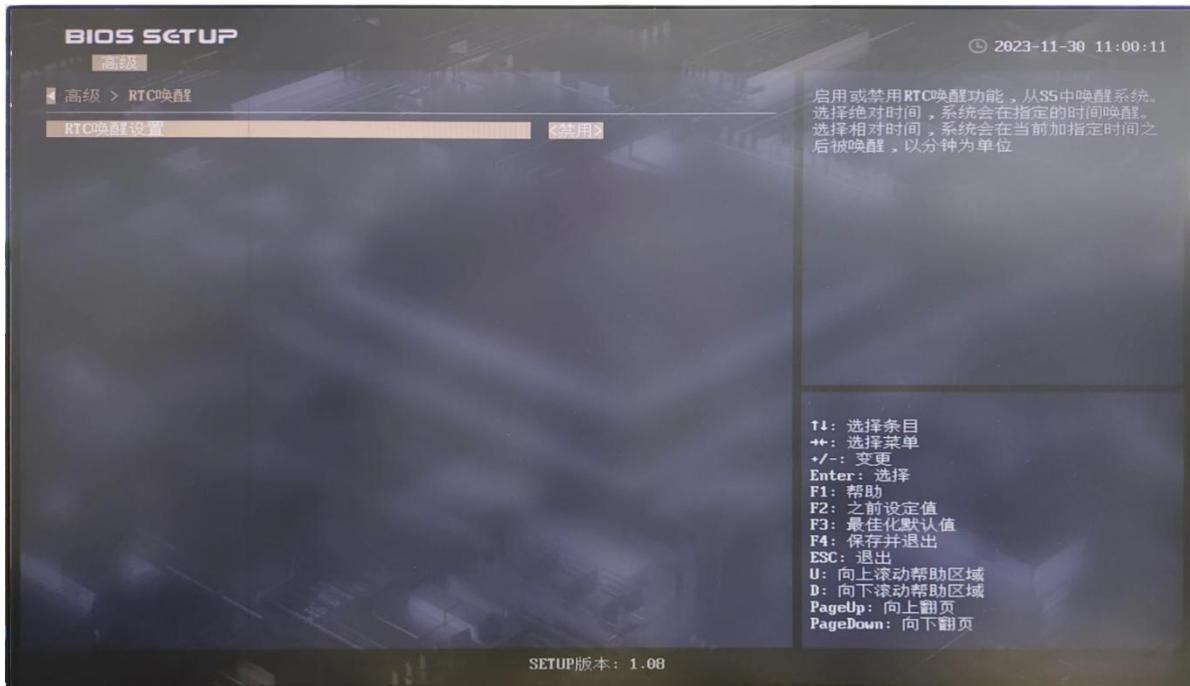
图 3-3 RTC 唤醒配置界面
