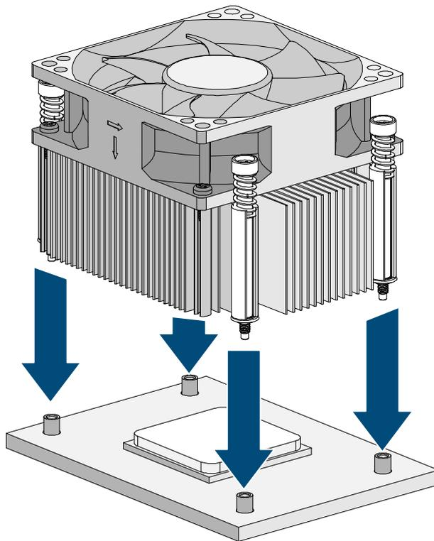
图 2-6 CPU 安装示意图
