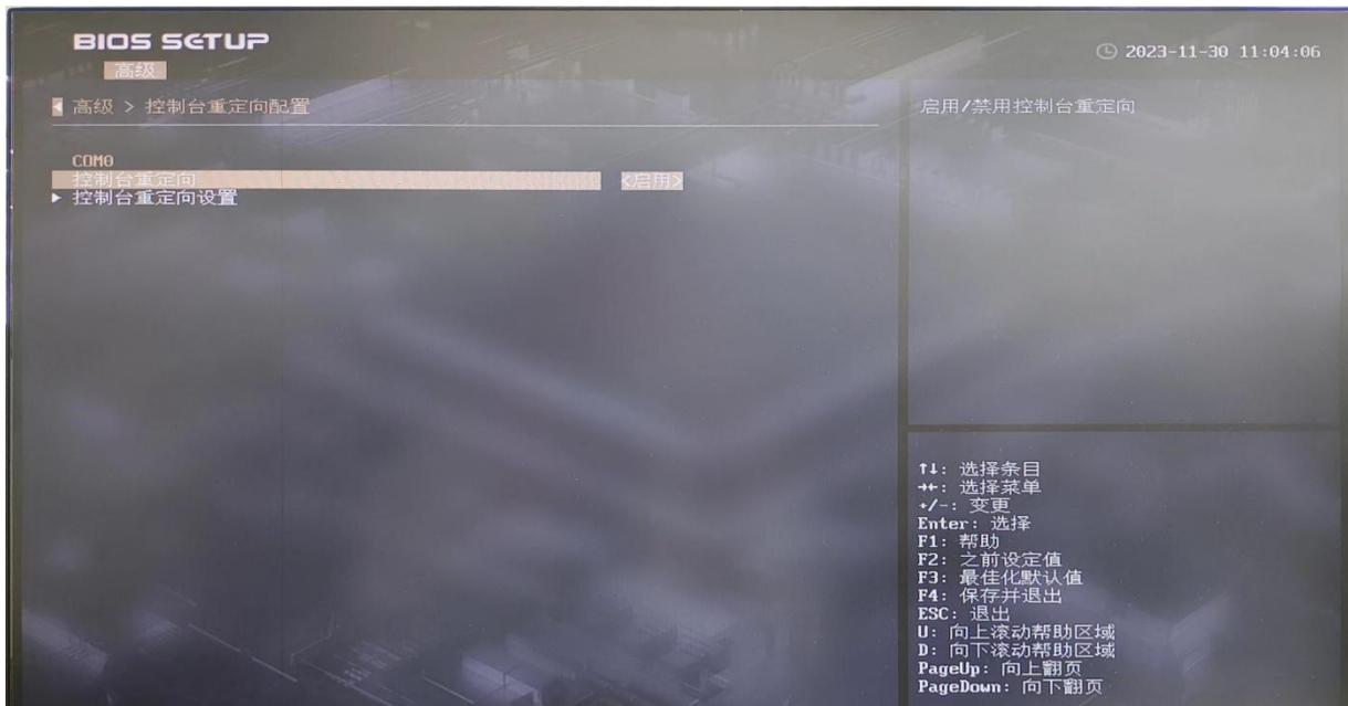
图 3-12 控制台重定向配置界面
