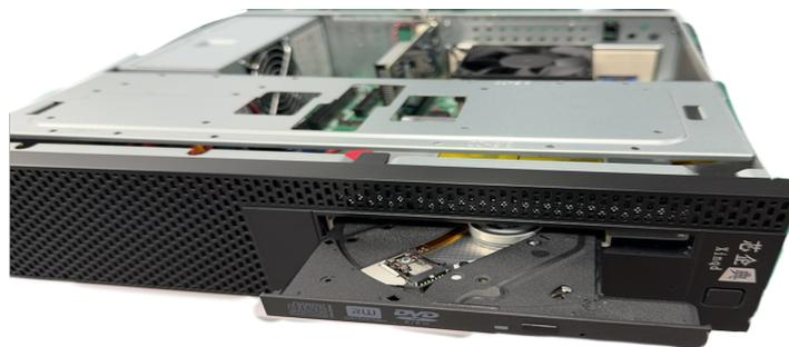
图 2-11 光驱拆装示意图
