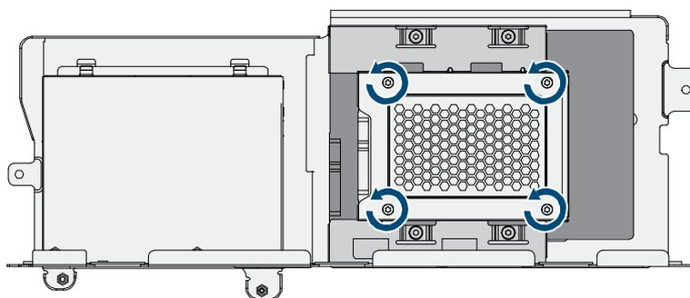
图 2-9 2.5 寸硬盘螺丝位置示意图
