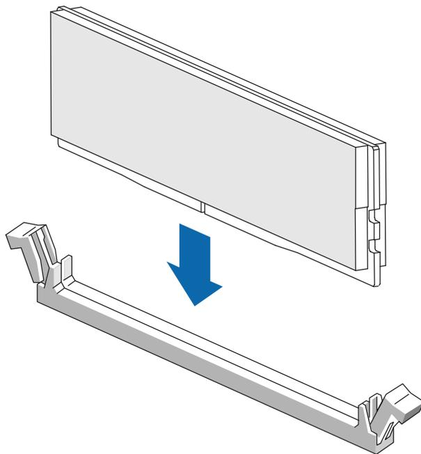
图 2-7 内存安装示意图
